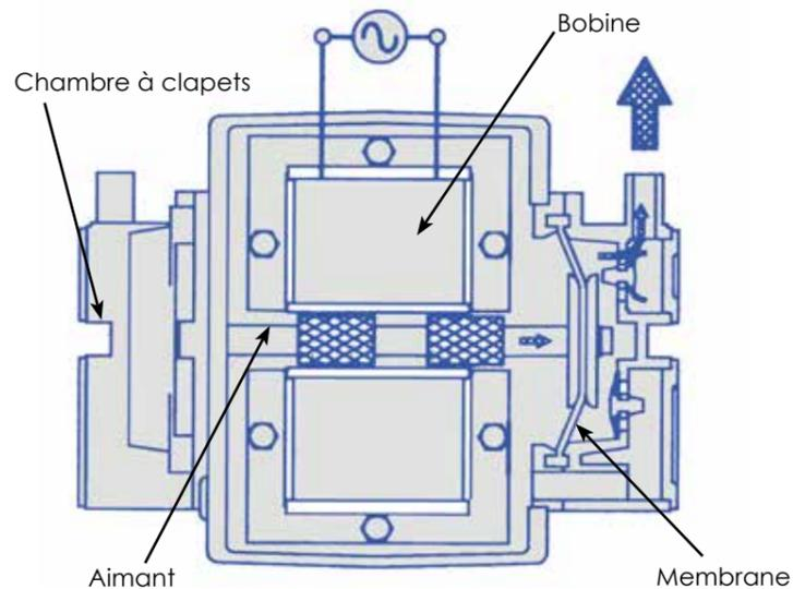
L'alimentation des électro-aimants entraîne un aimant permanent dans un mouvement oscillatoire. Ce dernier se déplace à la même fréquence que la tension d'alimentation, 50 ou 60 Hz.
