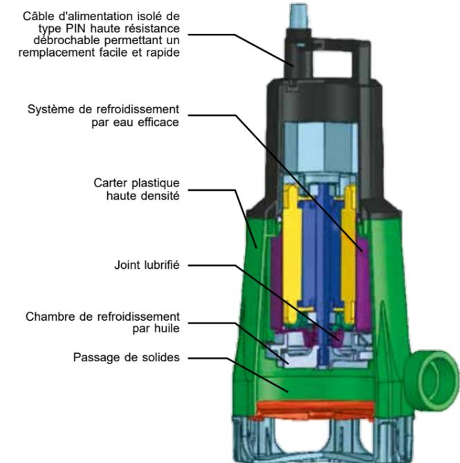
Quand le niveau d'eau est trop bas, l'interrupteur flotteur coupe automatiquement la pompe. La dernière génération de la série SM est équipée maintenant d'une puce qui régule électroniquement en vérifiant le niveau en continu et met en route ou arrête la pompe.
